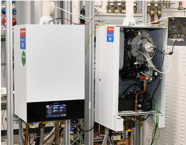
Bild 2: Zwei 100% H 2 -ready Prototypen auf dem Prüfstand: Nach der Erprobung folgen die Phasen der Qualifizierung, Dauererprobung und schließlich der Einsatz der neuen Geräte in realen Heizungsanlagen.
